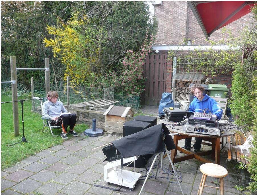
Afbeelding 22: Het tweede experiment voor het meten van rendement. Deze keer buiten, met dB meter, oscilloscoop, en Watt-meter. Omdat er 3 meetinstrumenten zijn, had ik nog een derde persoon nodig. Fabian, een vriend van mij, zit op de stoel met de dB meter, en een gehoorbeschermer, omdat hij aan de hoogste geluidsintensiteiten blootgesteld zal worden.
