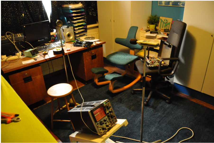
Afbeelding 20: Het eerste experiment voor het meten van het rendement van een luidspreker. Midden onder zie je de oscilloscoop, daarboven de dB-meter, en links boven de luidspreker. Dit gebeurde binnen, tot ik er achter kwam dat de muren geluid weerkaatsten.
