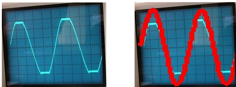
Afbeelding 4: Geclipt signaal (links) en signaal zoals dat had moeten zijn (rechts, in rood).
