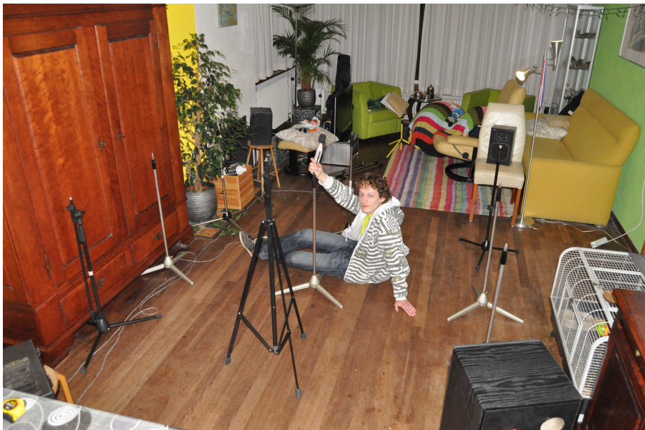
Afbeelding 21: Het experiment voor het meten van de geluidsverdeling. Ieder statief is een meetpunt, daar wordt de dB-meter op gehouden.
